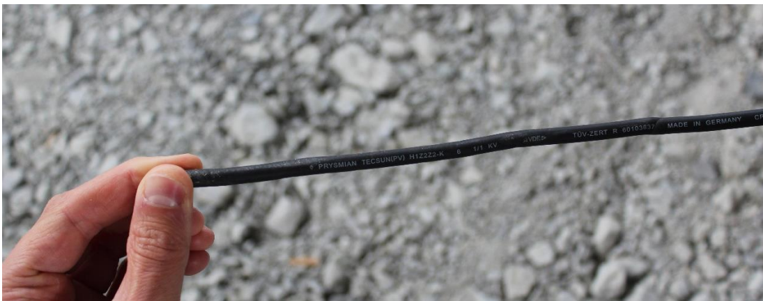
Bild 15: Verwendetes Verbindungskabel Typ PRYSMIAN TECSUN(PV) H1Z2Z2-K 6mm 2
