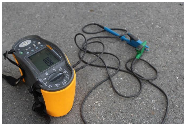
Bild 9: Messgerät mit geschlossenem Messkreis und Referenzmessung
