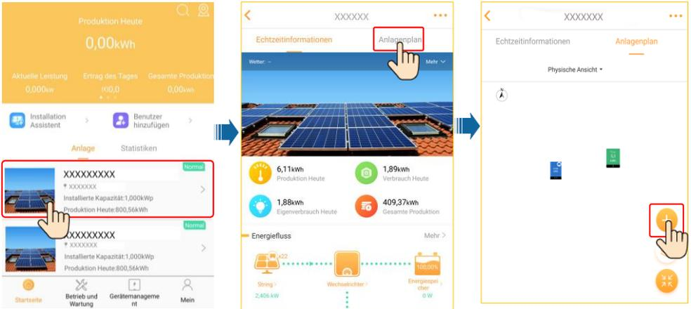
2. Melden Sie sich bei <https://intl.fusionsolar.huawei.com> an, um auf die Web-UI des FusionSolar Smart PV-Managementsystems zuzugreifen. Klicken Sie auf der **Startseite** auf den Anlagennamen, um die Anlagenseite aufzurufen. Wählen Sie **Anlagenplan**. Wählen Sie **Physische Ansicht hinzufügen** > **Mit KI generieren** und erstellen Sie nach Aufforderung eine physische Layoutvorlage. Sie können ein Layout des physischen Standorts auch manuell erstellen.
