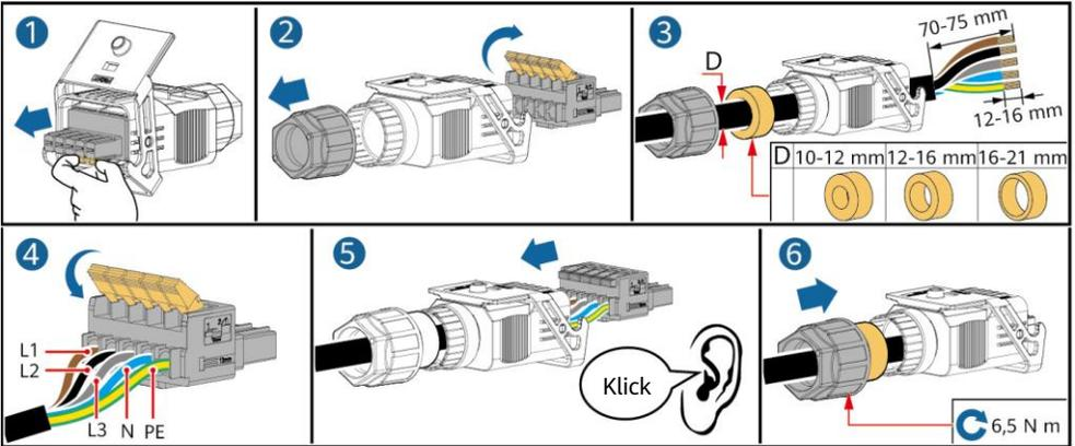
2. Schließen Sie den AC-Steckverbinder an den AC-Ausgangsanschluss an.
