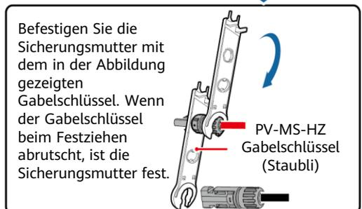
Befestigen Sie die Sicherungsmutter mit dem in der Abbildung gezeigten Gabelschlüssel. Wenn der Gabelschlüssel beim Festziehen abrutscht, ist die Sicherungsmutter fest.
