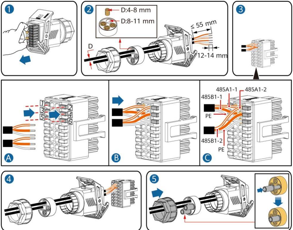
2. Verbinden Sie den Signalkabelverbinder mit dem Kommunikationsport.
