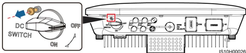
4. Schalten Sie den DC-Schalter (falls vorhanden) zwischen dem PV-String und dem Solarwechselrichter ein.
