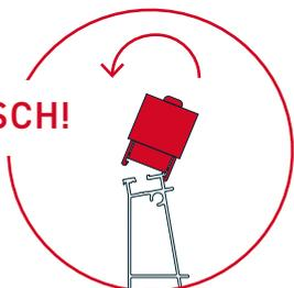
Mittel- und Endklemmen **I** an der Seite des Towers **E**, die der Base **C** zugewandt ist an der unteren Führungsnut ansetzen und auf die gegenüberliegende Führungsnut aufdrücken bis die Klickrastung mit hörbarem Geräusch einrastet.
