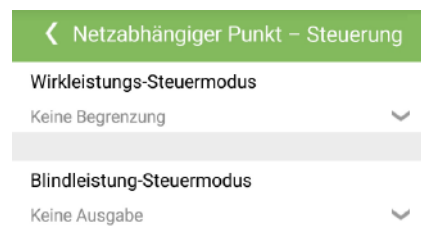
Abbildung 7-15 Steuerung des netzgekoppelten Punkts
