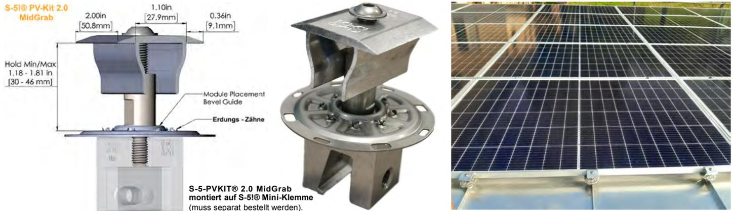
Das S-5-PVKIT® 2.0 ist geeignet für gerahmte PV-Module mit Rahmenhöhen von 30mm bis 46mm. Die Montage erfolgt mit den für den jeweiligen Stehfalz geeigneten S-5!®-Mini-Klemmen. Die Edelstahl-Modulauflagescheibe des PV-Kit 2.0 verfügt über optimierte Zähne die die Erdung der Module ermöglicht. Es sind deshalb keine Laschen oder Drähte für die Verbindung der einzelnen Module in der Reihe erforderlich, außer zum Verbinden einer Modulreihe mit einer anderen und zur Erdung des kompletten Systems.
